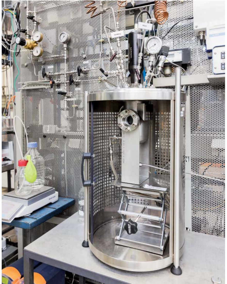
Im kontinuierlichen Rührkesselreaktor der Miniplant läuft die chemische Reaktion ab. Die gleichmäßige Vermischung der Reaktanten wird durch ein integriertes Rührwerk erreicht.
