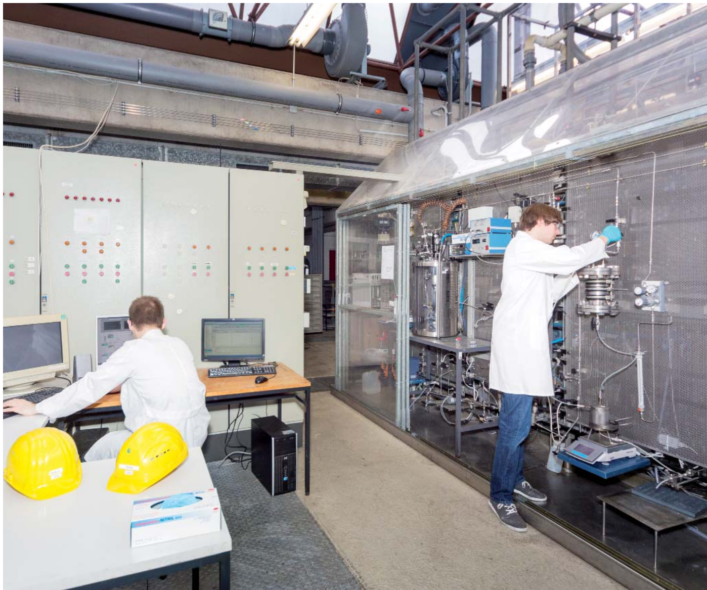
Die Miniplant, eine Industrieanlage im Kleinformat an der TU Dortmund, ist das Herzstück des SFB/Transregio: Hier wird umgesetzt, was in den unterschiedlichen Teilprojekten vorab erforscht wurde.
