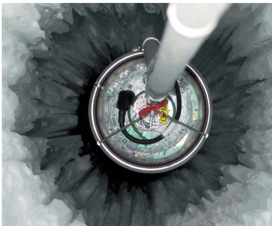
Blick ins große Neutrino-Teleskop IceCube: Es liegt rund eineinhalb Kilometer unter der Eisoberfläche und besteht aus 5160 kugelförmigen Detektoren, von denen jeder ungefähr so groß ist wie ein Basketball.
