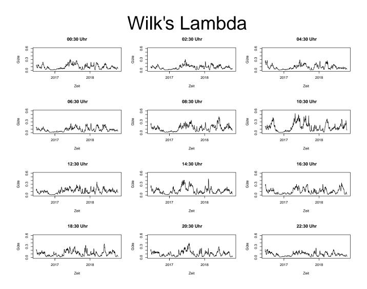
Abbildung 6: Gütekriterium Wilk's  $\Lambda$  zur Ermittlung der Modellanpassung eines Multivariaten Linearen Modells zur Vorhersage von Rissen im Baumaterial einer Brücke
