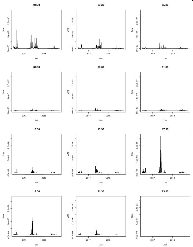
Abbildung 62: Gütekriterium basierend auf der MVE-Schätzung zur Ermittlung der Modellanpassung eines robusten Multivariaten Linearen Modells zur Vorhersage von Rissen im Baumaterial einer Brücke
