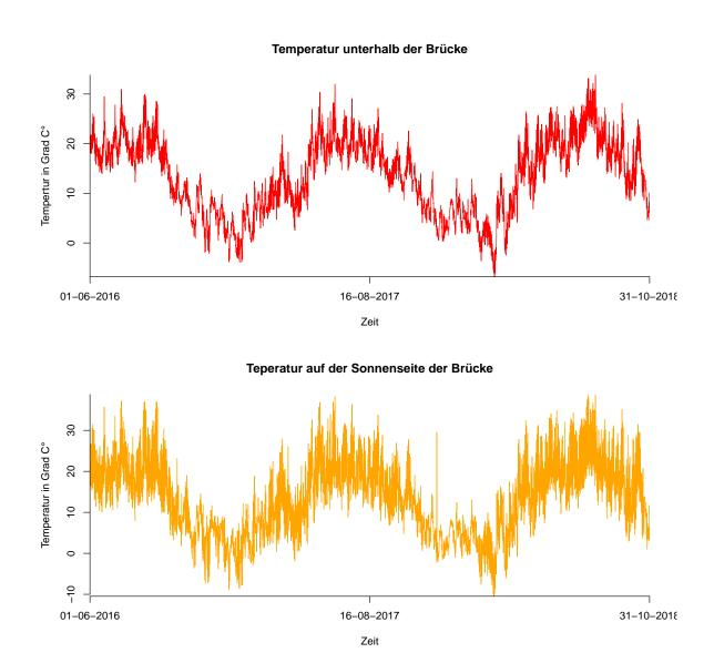
Abbildung 4: Messergebnisse des Temperatursensoren unterhalb und oberhalb der Brücke über gesamten Messzeitraum
